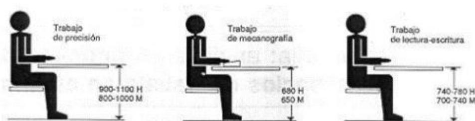
Figura 25. Altura del plano de trabajo para puestos de trabajo sentado (cotas en mm)
