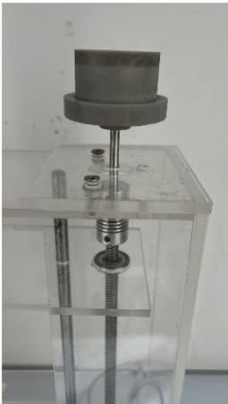
Fig. 6.0 Perilla del eje control
