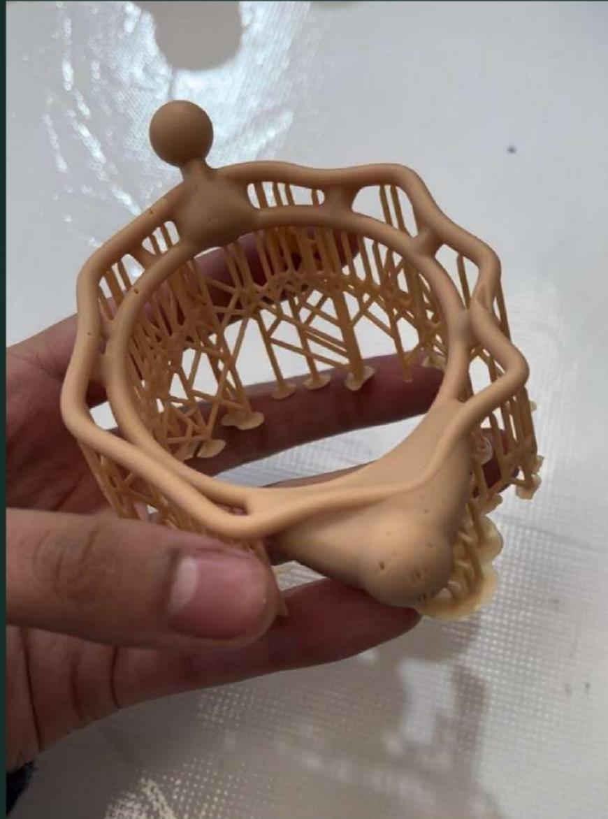
Figura 94: Impresión 3D de la Pulsera 2B en Resina MODEL.
