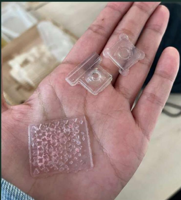
Figura 24: Impresión Resina, Elastic 50A.
