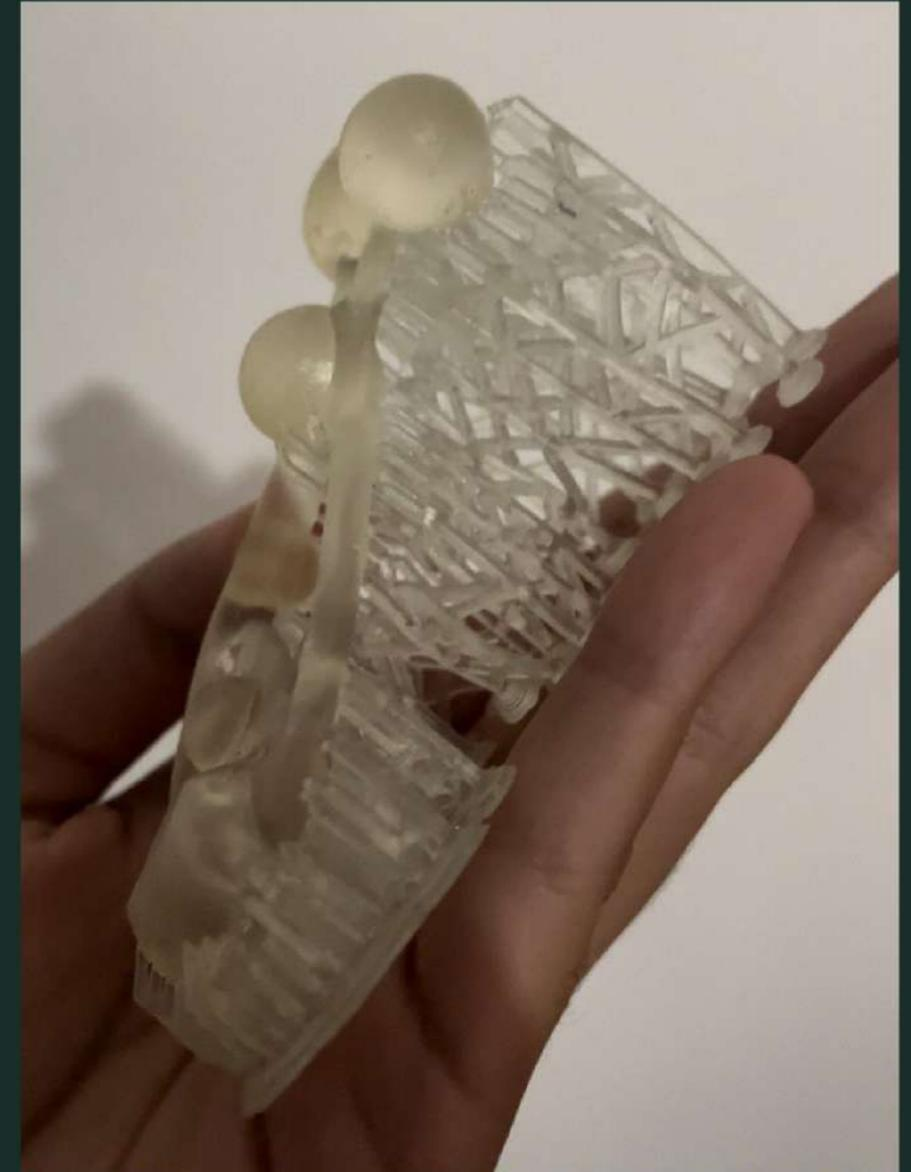
Figura 82: Soportes del prototipo Resina Elastic 50A.
