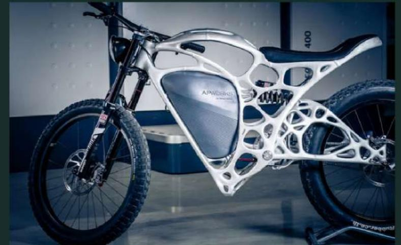
Figura 23: APWORKS es una motocicleta impresa en 3D hecha por medio del diseño generativo por Altus Group.
