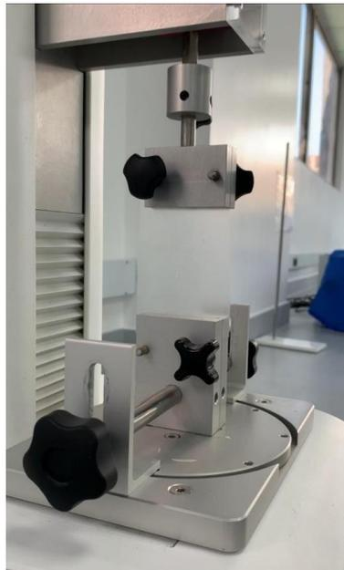
**Figura 7-3** Prueba de tracción y elongación en recubrimiento, texturómetro TX-700
