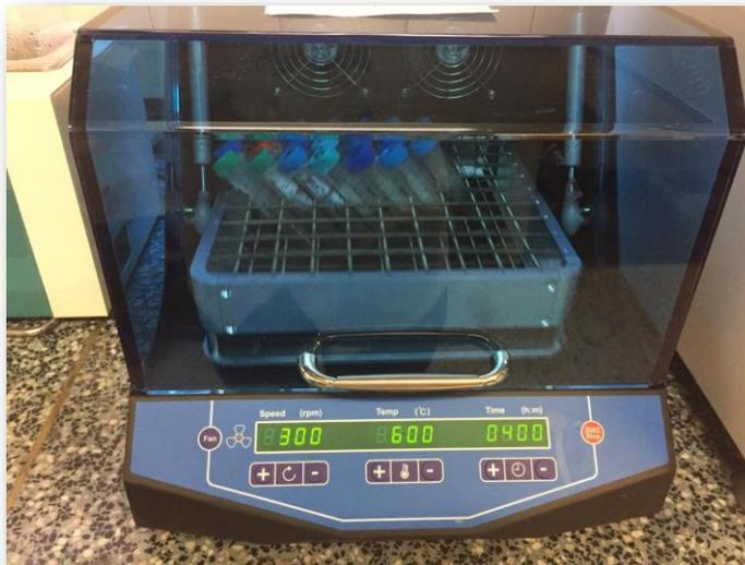
*Imagen 21: Agitación continua en el agitador orbital. Fuente: (Autor, 2019)*
