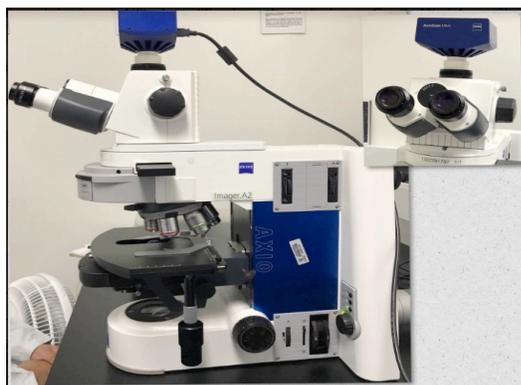
**Figura 3.** Microscopio óptico (ZEISS Axio Lab.A1) cámara de video (Axio camHRm)
