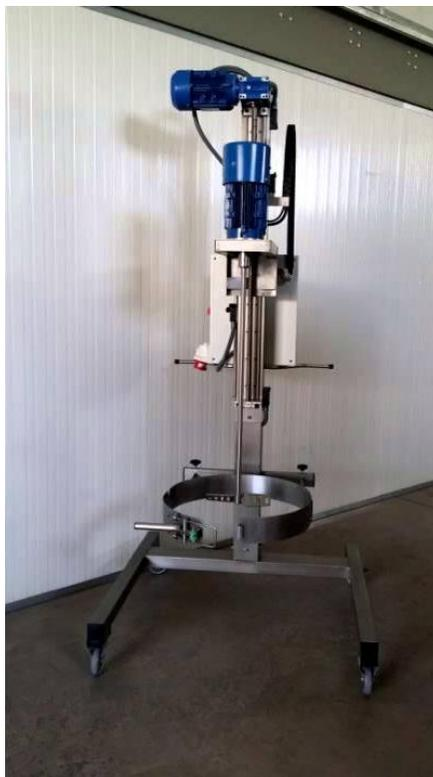
**Figura 20.** Agitador eléctrico
