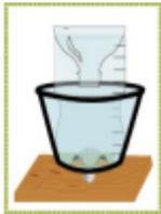
5. Se coloca la botella con el embudo dentro del balde. Así se recolecta la lluvia.
