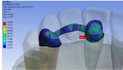
Figura 23. Aplicación de carga sobre la matriz preliminar de mayor moda de la aleacion Au-Pd sobre periodonto normal, estructura metalica. Realizado por ingeniero Ricardo Rios.
