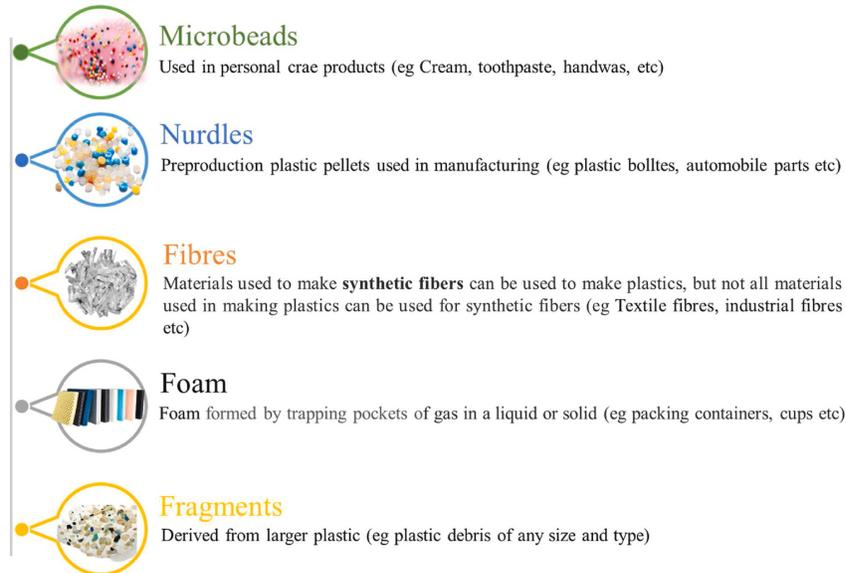
**Figura 2.** Clasificación de microplásticos según su forma estandarizada y sus aplicaciones, mostrando microgránulos, perlas, fibras, espuma y fragmento
