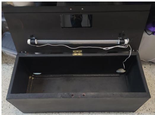
**Figura 33.** Caja negra de simulación de condiciones experimentales. Elaboración propia
