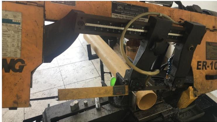
Figura 79. Corte de tubo de 4" en cortadora sinfín.
