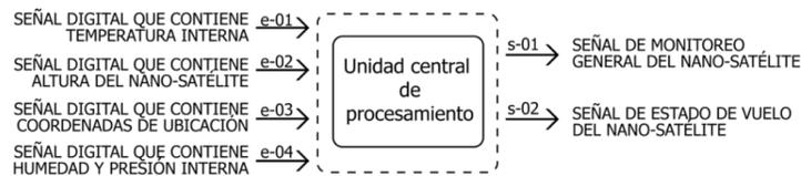
Figura 39. Estructura funcional de la unidad central de procesamiento.
