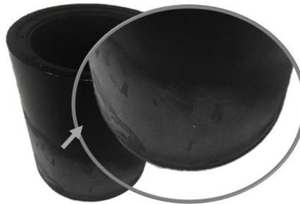
*Figura 124. Detalle de congelamiento de la cápsula externa extraída del congelador.*
