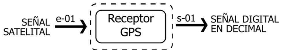
Figura 27. Estructura funcional del receptor de GPS.
