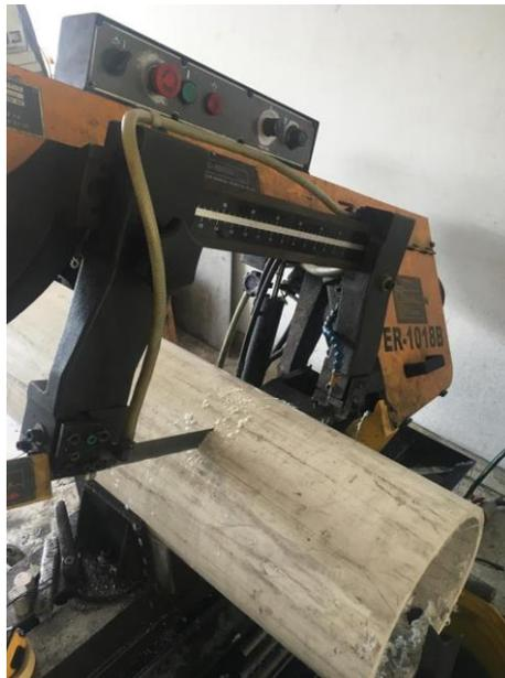
Figura 80. Corte de tubo de 10" en cortadora sinfín.
