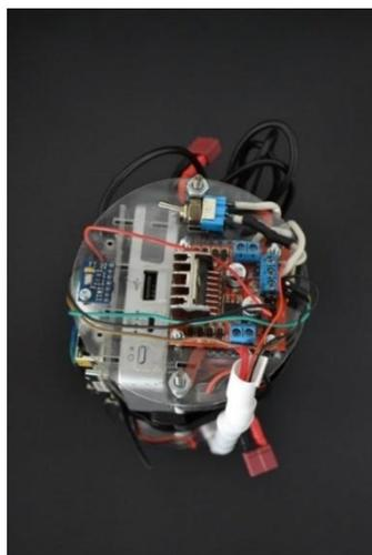
*Figura 107. Vista superior de los componentes electrónicos incorporados en la estructura del nano-satélite.*
