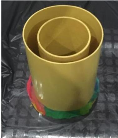
*Figura 81. Ajuste de tubos para rellenarlos de espuma.*
