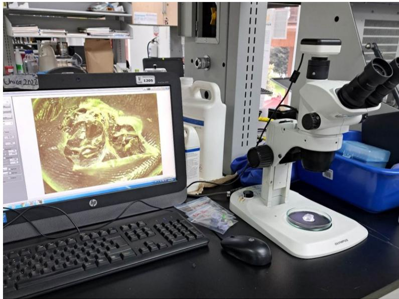
*Figura 11. Toma de fotografía de impresiones del área de contacto con stereomicroscopio. Foto realizada por Paula Andrea Ramirez.*
