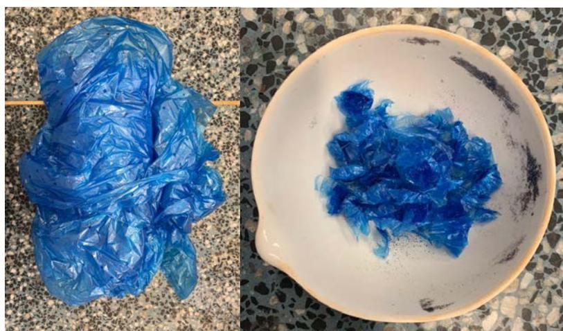
Figura 55. Proceso de secado y trituración de las muestras de PEBD
