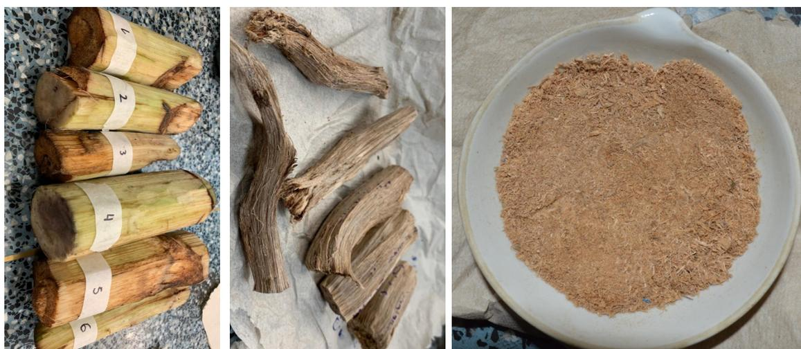
Figura 41. Proceso de corte, secado y tritución de las muestras de vástago
