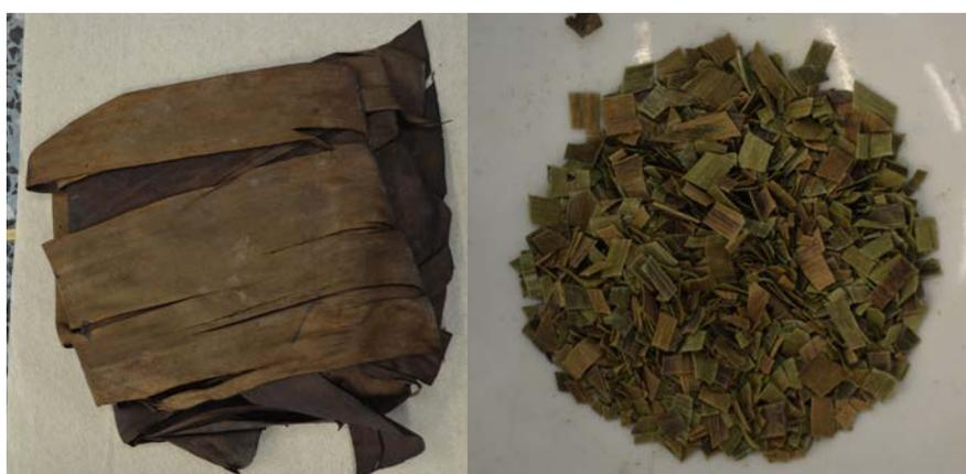
Figura 42. Proceso de corte, secado y tritución de las muestras de residuos foliares
