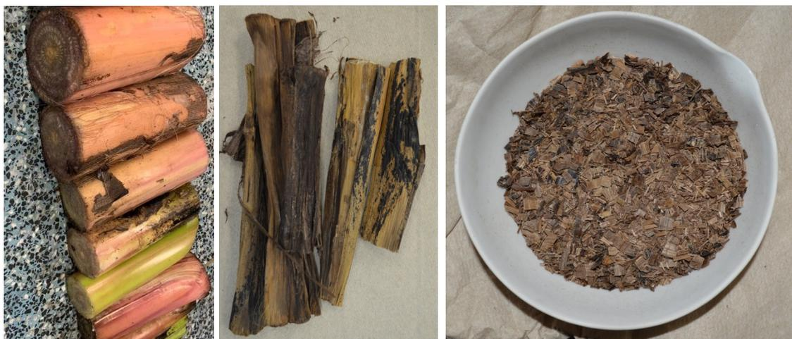
Figura 40. Proceso de corte, secado y tritución de las muestras de pseudotallo
