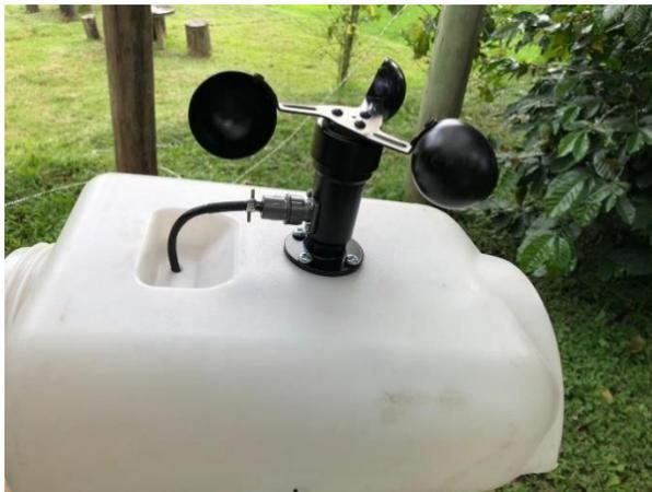
Figura 75 Ensamble de Anemómetro
