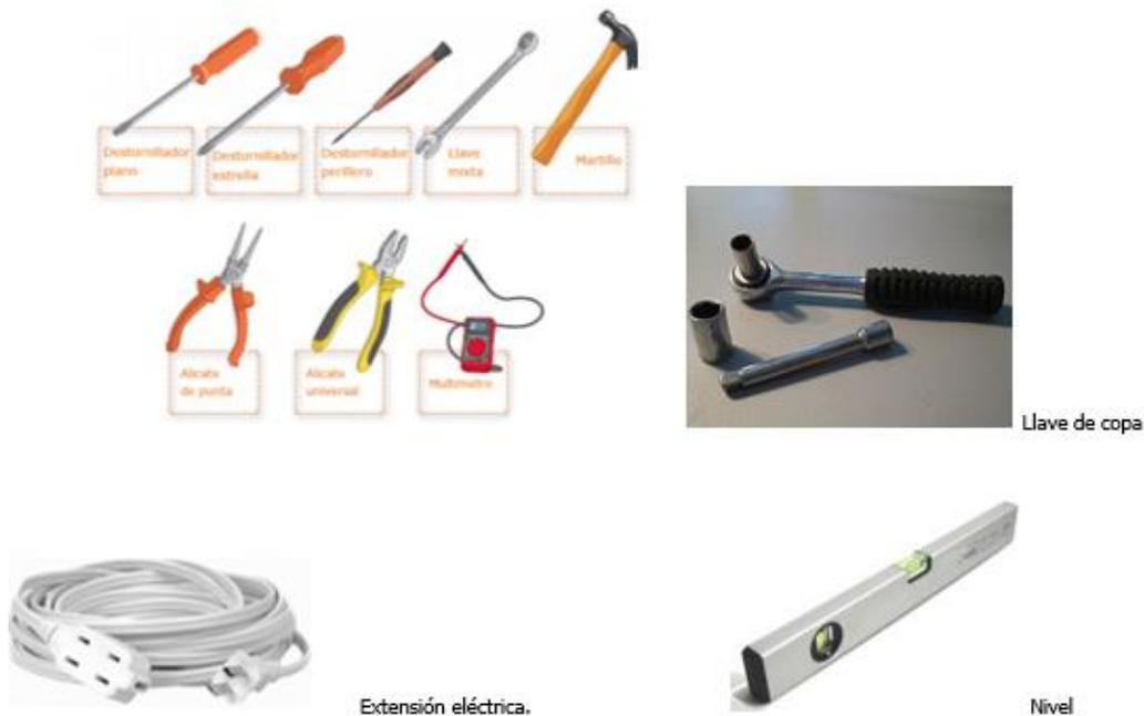
Figura 67 Herramientas de mano para instalación.
