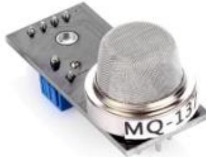
Figura 13 Dispositivo MQ-137 NH3.
