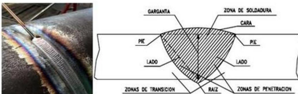
Figura 28 Unión por soldadura en arco.
