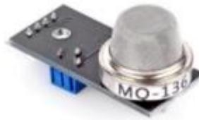
Figura 15 Dispositivo MQ-136
