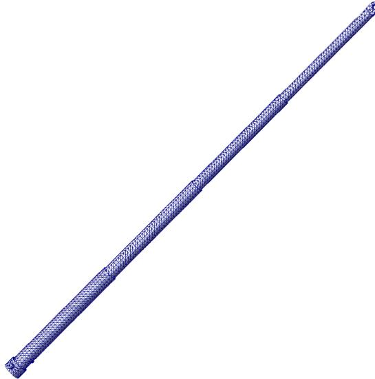
*Figura 24. Modelo mallado de dispositivo telescópico lineal*
