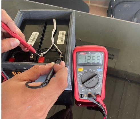
Figura 71. Prueba voltaje de salida de baterías conectadas en paralelo.
