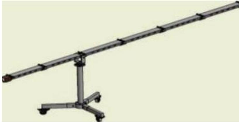
Figura 20. Dispositivo telescópico manual para porte de una cámara (Chicaiza y Guerrero, 2016).
