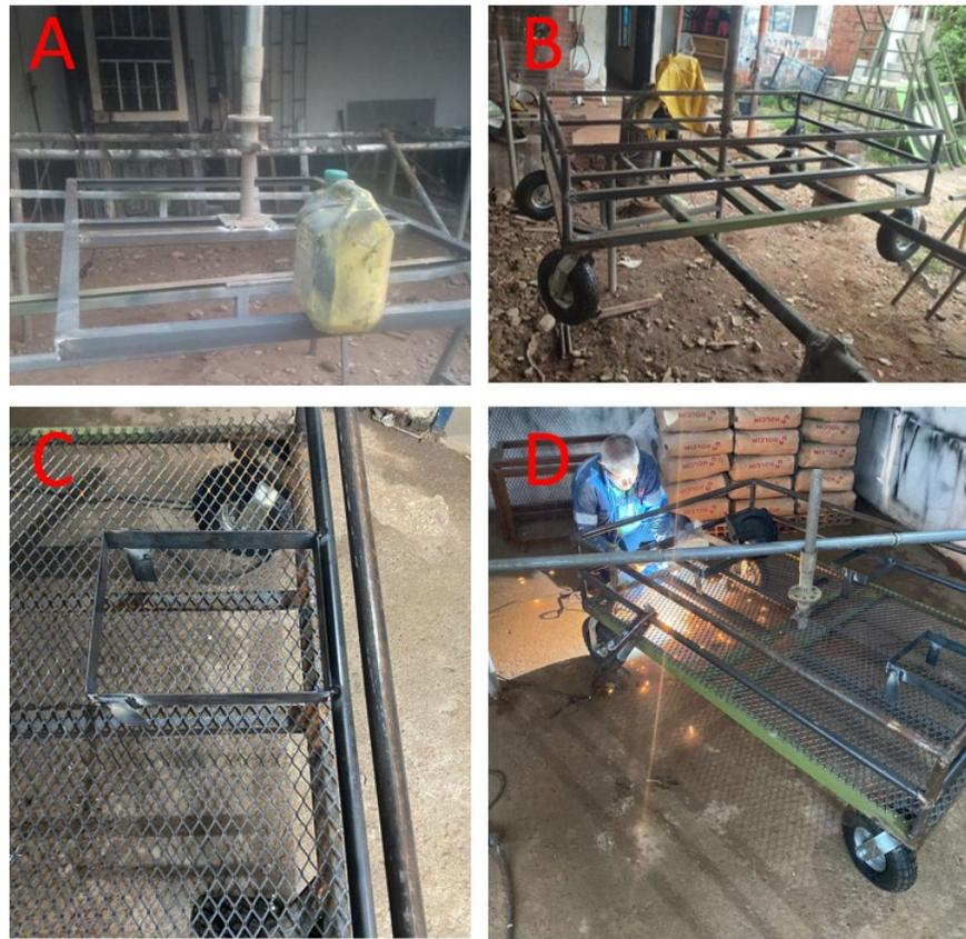
Figura 65. Construcción sistema transportador del prototipo. A: Base tubular del sistema. B: Chasis tubular terminado y acople de las ruedas. C: Soporte de contenedor líquido. D: Soldadura de la malla al chasis.
