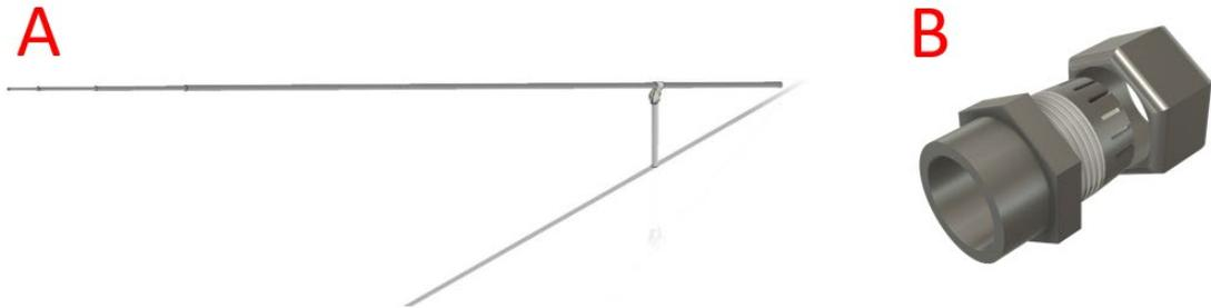
Figura 59. Diseño asistido por computadora (CAD) de A: Brazo telescópico modular y B: Juntas de módulos del sistema telescópico
