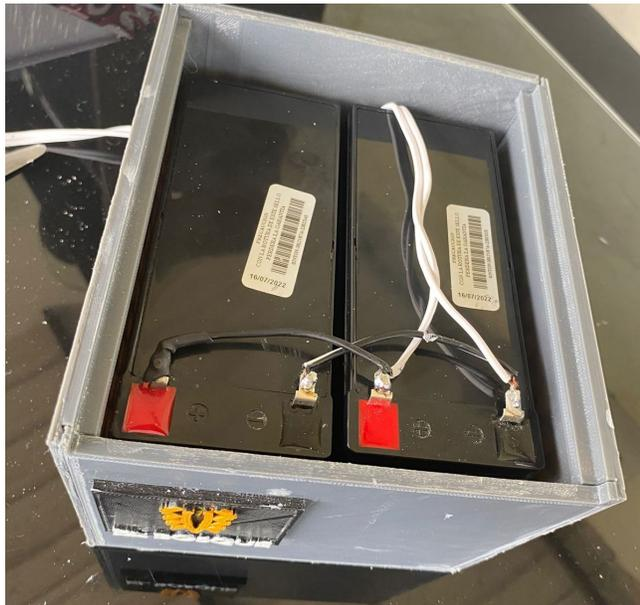
*Figura 68. Ensamblaje y soldadura de las baterías con la caja de protección.*
