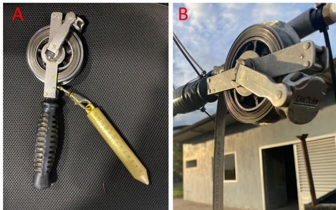
*Figura 72. Cinta plomada de medición para pruebas control.*
