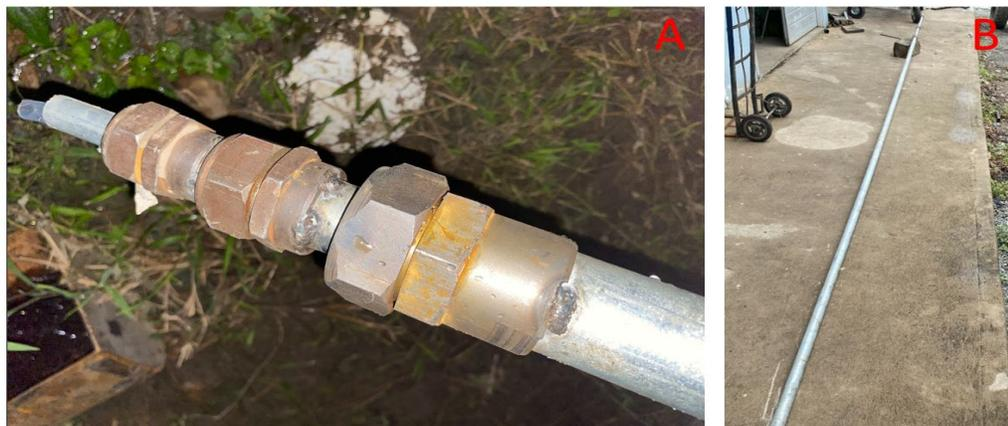
Figura 67. Ensamble del brazo telescópico. A) Juntas de acople del brazo telescópico modular. B) Ensamblaje de módulos del brazo telescópico.
