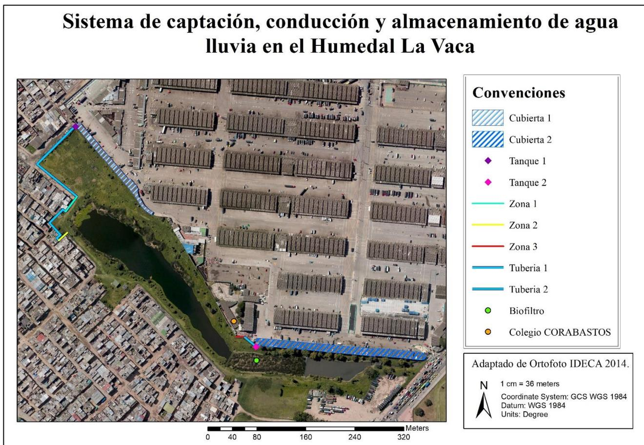
Figura 27. Sistema de captación, conducción y almacenamiento de agua lluvia en el HLV.
