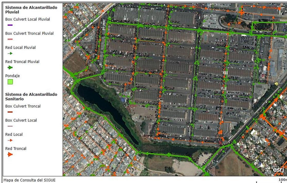
Figura 12. Sistema hidrosanitario (pluvial y sanitario) de la zona de estudio.
