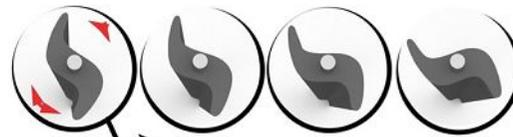
La rotación de los módulos sobre su eje permite cámaras de aire grandes o pequeñas
