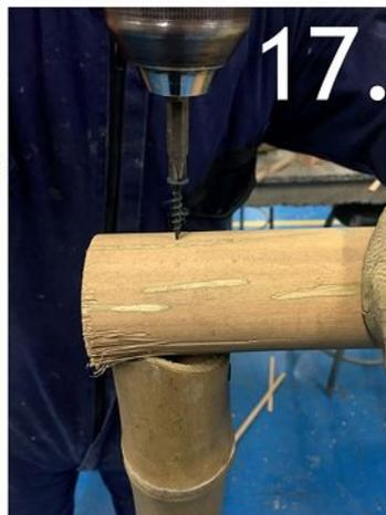
Fijar todas la uniones con tornillo de madera para estructurar de la mejor manera el panel.
