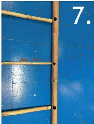
Realizar el ensamblaje del varillón de guadua con los ejes de caña brava para la realización del tejido.
