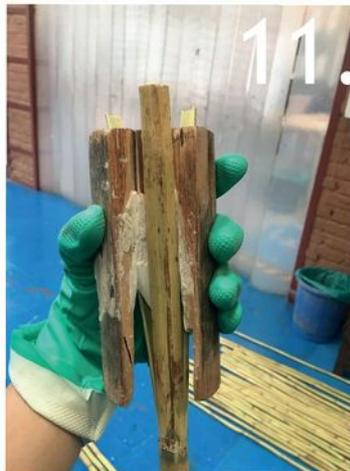
Ejercer presión del cañizador sobre la caña para generar el corte longitudinal.
