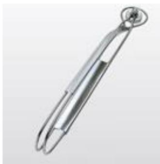
*Figura 282. Pinzas magnéticas para prensa*
