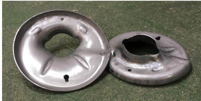
Figura 124. Plato para amortiguador
