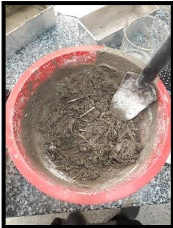
La ilustración 10 presenta la mezcla de cáñamo, tierra, cal hidratada y cemento, para la mezcla se empleó un palustre y la adición de agua en pequeñas cantidades.
