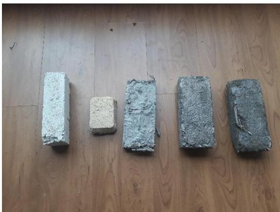
la siguiente ilustración muestra los 5 producto mínimo viables que se diseñaron durante la investigación cabe resaltar que se escogieron los 3 ladrillos que mostraban el mejor proceso de secado para las pruebas .
